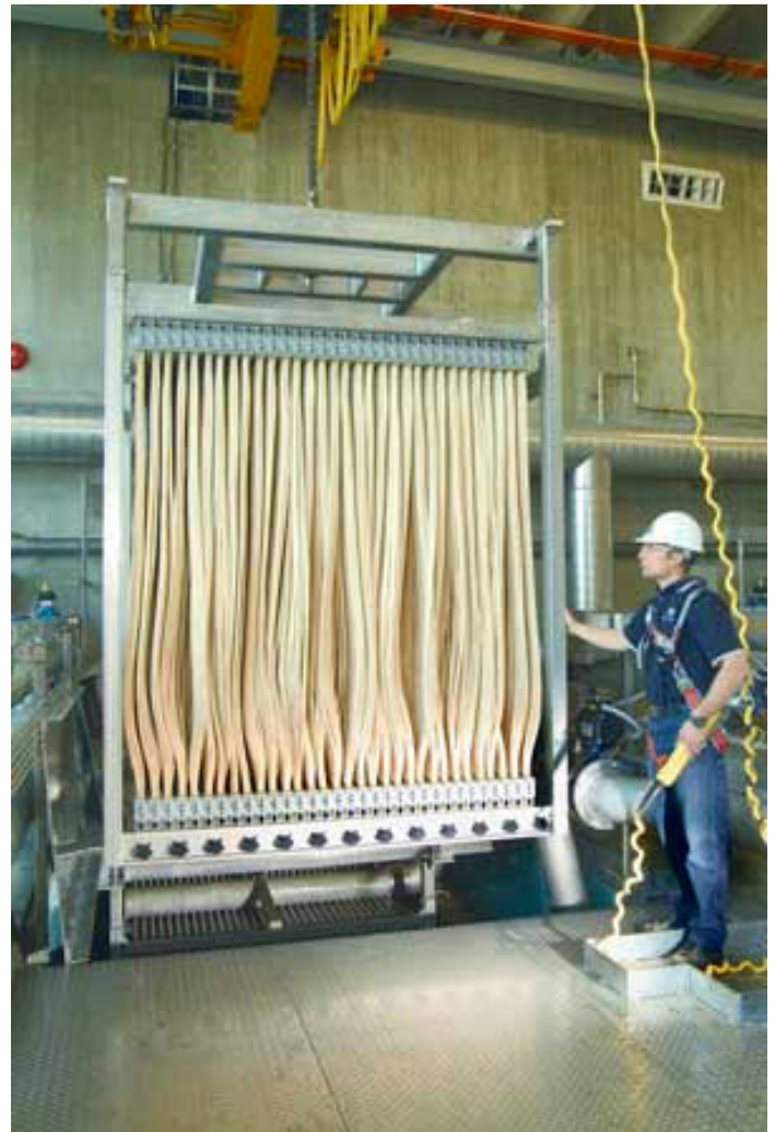
Figura 5.2 Esempio di modulo a membrane a fibra cava
